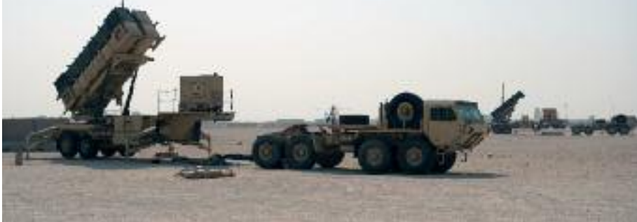
PAC-2 GEM-T füzeleri ile donatılmış M901 Fırlatma İstasyonları göreve hazır şekilde beklerken görülmüştür [Fotoğraf: İnternet].
