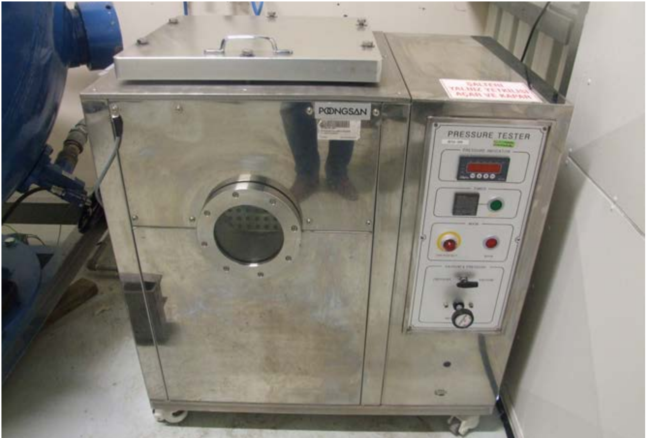
Sızdırmazlık Test Sistemi
