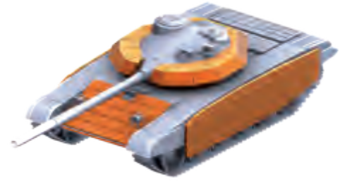
Paletli Zırhlı Araç Üzerine Reaktif Zırh Uygulaması
