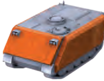
Ana Muharebe Tankı Üzerine Reaktif Zırh Uygulaması
