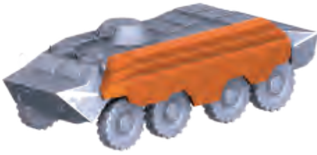
Tekerlekli Zırhlı Araç Üzerine Reaktif Zırh Uygulaması
